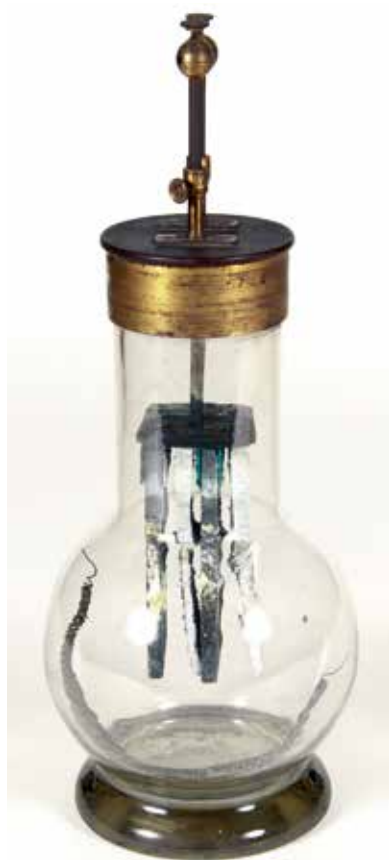
Abbildung 5: Akkumulator (Bunsen'sches Tauchelement) mit vier Kohle- beziehungsweise Zinkplatten, etwa 1870 bis 1880 (H 42,7 cm) (Inv.-Nr. III O 414)
