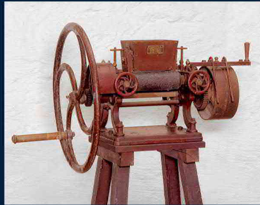
Dreiwälzensalbenrührwerk für Transmissions- oder Handbetrieb (um 1870)
