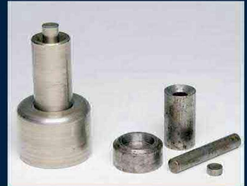
Handtablettenpresse mit Stahlzylinder und zwei Stempelstücken (Anfang 20. Jh.)
