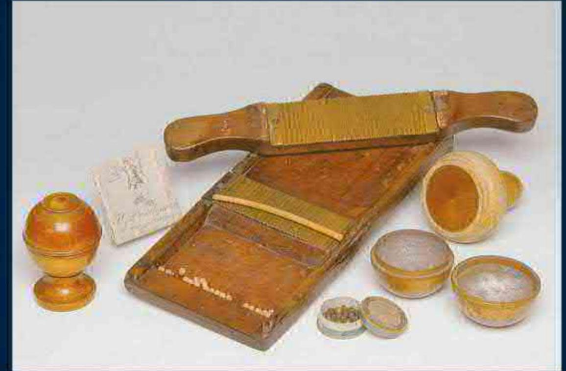
Pillenmaschine und Hilfsmittel zur Herstellung (19. Jh.)
