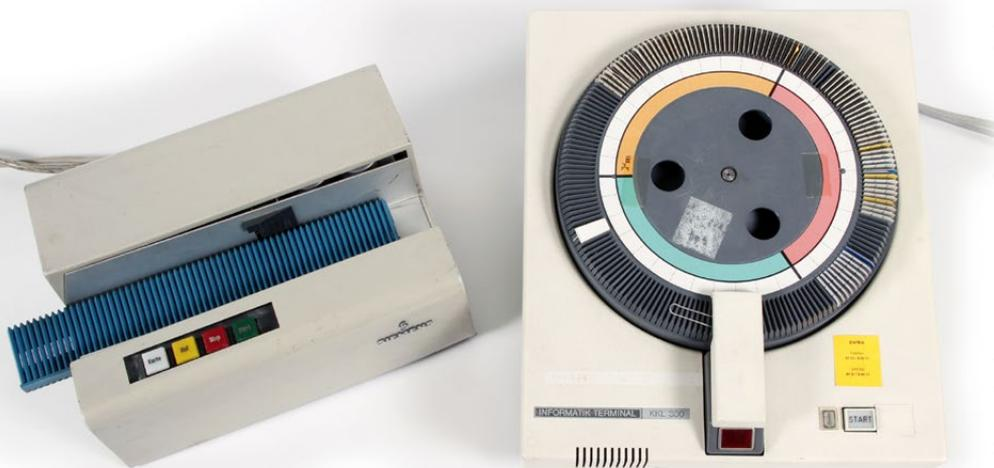
Abbildung 1: Kleinkartenleser der ersten Generation: der 1969 eingeführte Transdata K 36 von Siemens mit geradem Schlitten für Lochkärtchen (Inv.-Nr. III S 7) und der 1970 von SEL entwickelte KKL 300 mit Karussellmagazin (Inv.-Nr. III S 32)
