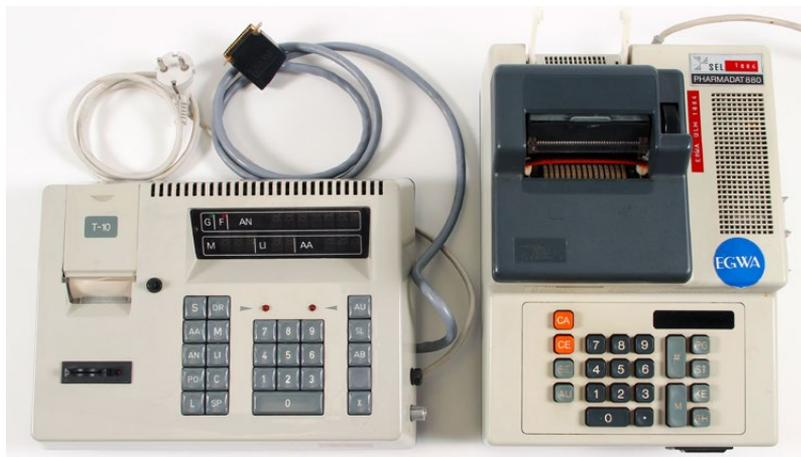
Abbildung 2: Kleinkartenleser der zweiten Generation: Ein Quantensprung im Vergleich zum Siemens Transdata K 36 und dem KKL 300 waren der T 10 der Firma LOS (Inv.-Nr. III S 29) und der SEL-Pharmadat, hier das Modell 880, um 1980 (Inv.-Nr. III S 20) mit RAM-Speicher, Display, Tastatur, Druckeinheit und Einzelsteckplatz für ABDA-Lockkarte
